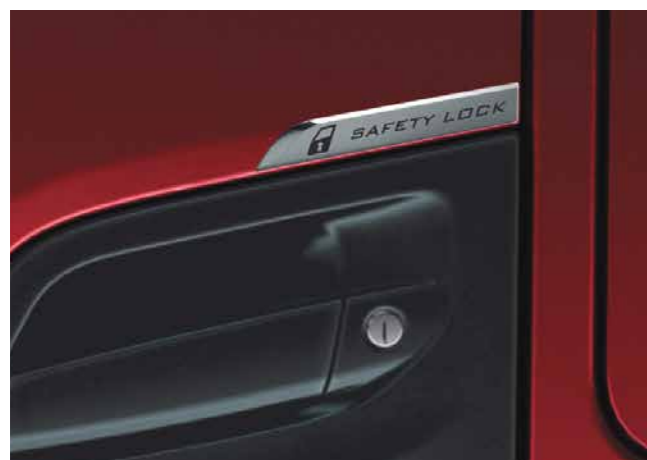
De centrale portiervergrendeling kan worden uitgebreid met een nachtbeveiligingslot om de chauffeur van een zorgeloze nachtrust te verzekeren.
